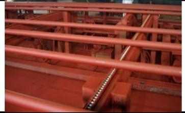
該塗料是由水性醇酸、變性丙烯酸樹脂、防銹顏料組成的水性快乾臨時防銹塗料。採用有氣/無氣噴塗的方式塗裝在C型梁、方管、甲板等各種鋼結構上。它乾燥速度快，具有優異的粘合性和令人滿意的機械性能。
